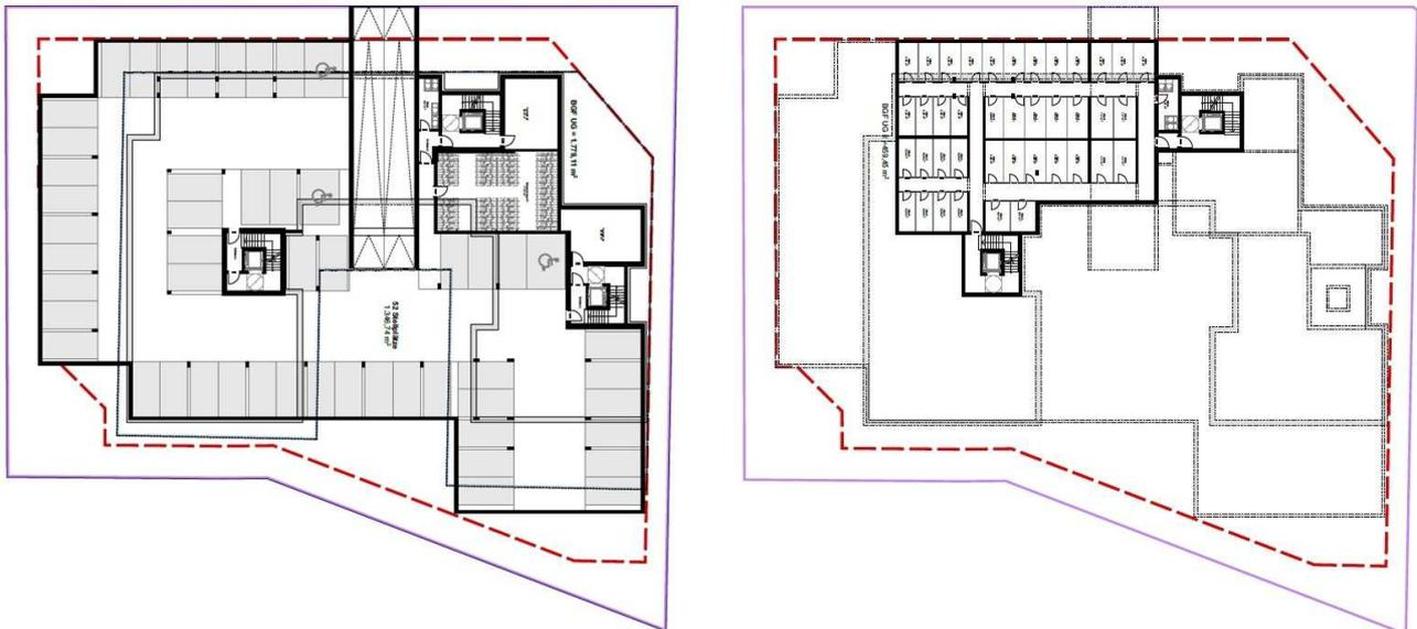
Abbildung 3: Übersicht Grundrisse Untergeschoss I (links) und Untergeschoss II (rechts) „Stonsdorfer Weg“ (PLAN<sup>2</sup>IA Architekten, 2021).
