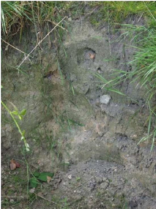
**Foto 2: Aufbau Humoser Oberboden und mineralische Ausgleichschicht OB 7**
